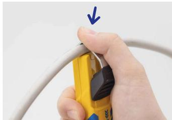
Dank des im Metallbügel integrierten Sichtfensters kann die Klinge leicht an der richtigen Stelle angesetzt werden. Zudem ermöglicht es eine Sichtkontrolle, ob der Schnittverlauf in Ordnung ist.
